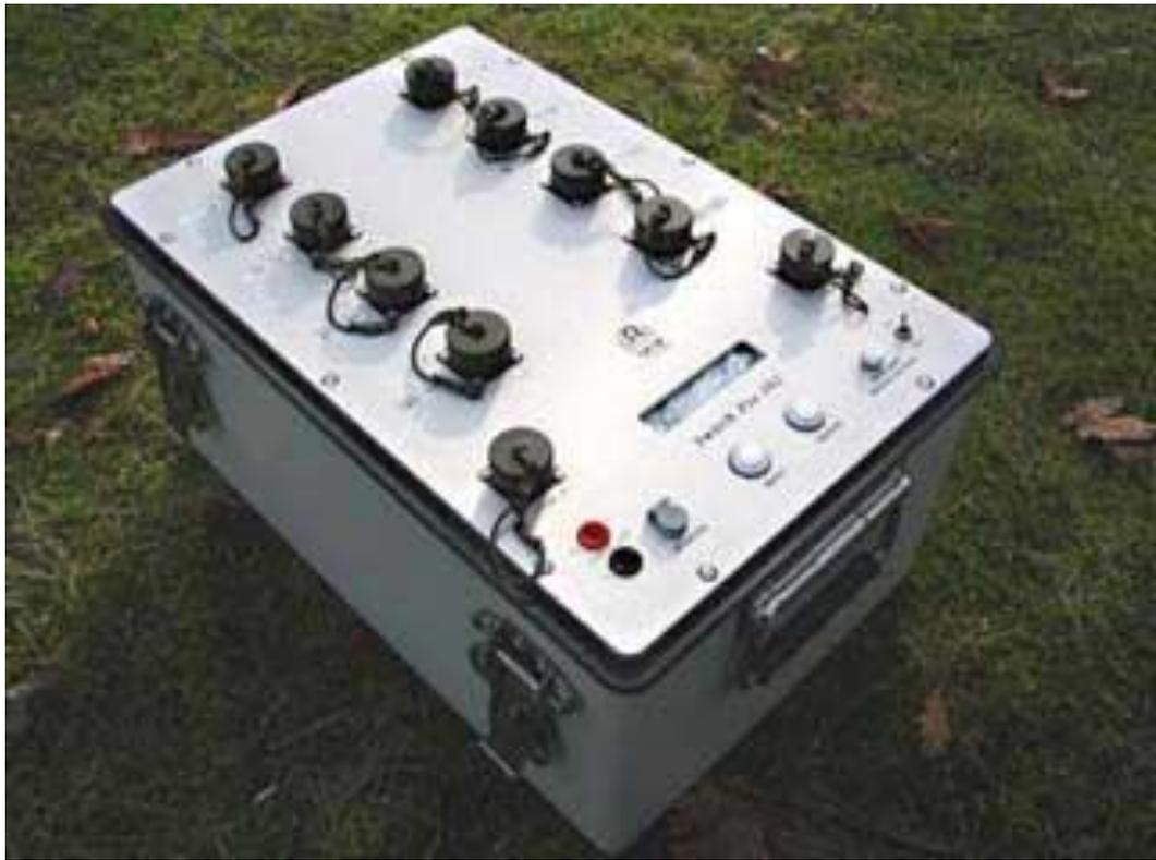
Рисунок 5 – Коммутатор «SwitchPRO 240»
