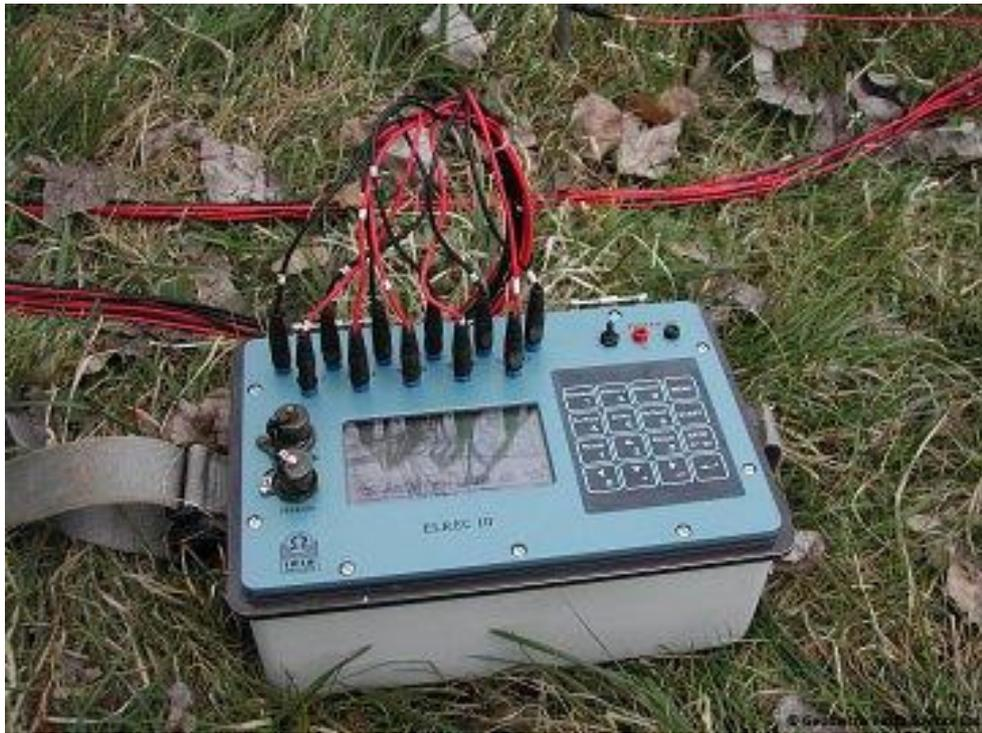
Рисунок 4 – Приемник «ElrecPRO»
